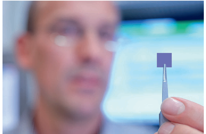
Ausgewertetes Dosimeter unter der Pinzette: Der Blauton verrät die applizierte Dosis – je dunkler die Färbung, desto höher die Energie, die das Produkt erhalten hat. © Markus Steur
