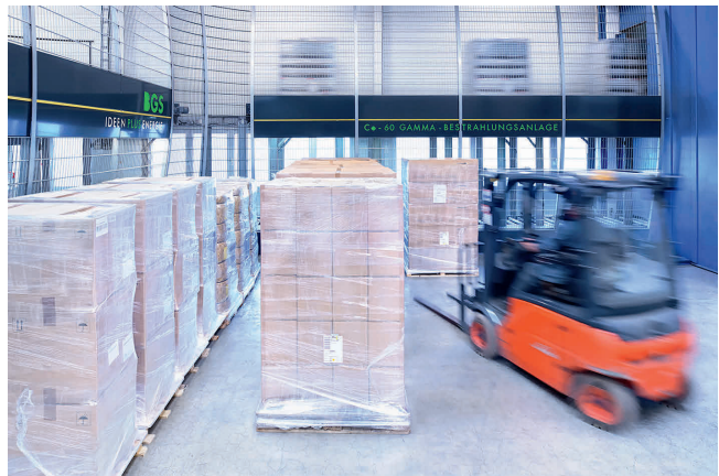
Verpackte Paletten kurz vor dem Transport in die Bestrahlung. Wie die Ware auf der Palette steht, ist keine Nebensache: Packdichte und Anordnung entscheiden mit über die Dosis, die am Ende ankommt. © Markus Steur
