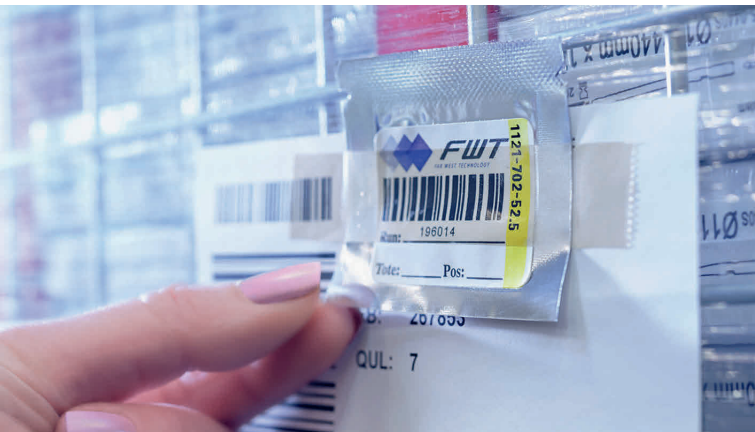
Das Nylonfilm-Dosimeter, vor der Bestrahlung an seiner Referenzposition fixiert. Barcode und Run-Nummer auf dem Etikett verknüpfen den späteren Messwert eindeutig mit Charge und Auftrag. © Markus Steur
