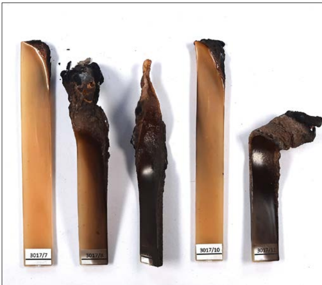
Bild 1: Strahlenvernetztes, flammgeschütztes PA 11 ohne (links) und mit Holzpartikel (rechts) nach der UL-94-Prüfung.
